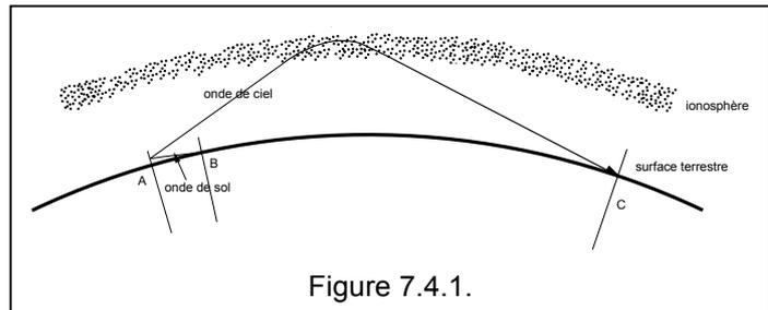
Lorsque l'onde a quitté l'antenne d'émission, elle se dirige vers le ciel où elle rencontre des couches ionisées. Cette région s'appelle l'**ionosphère**. L'ionosphère commence à environ 50 km de la terre et va jusqu'à 400 km. L'ionosphère est en fait un milieu dans lequel l'onde va être réfractée, à tel point que l'onde peut retourner vers la terre.
