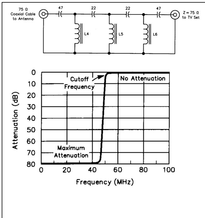
Le filtrage du côté émetteur peut s'avérer insuffisant, il faut alors filtrer aussi du côté récepteur.
