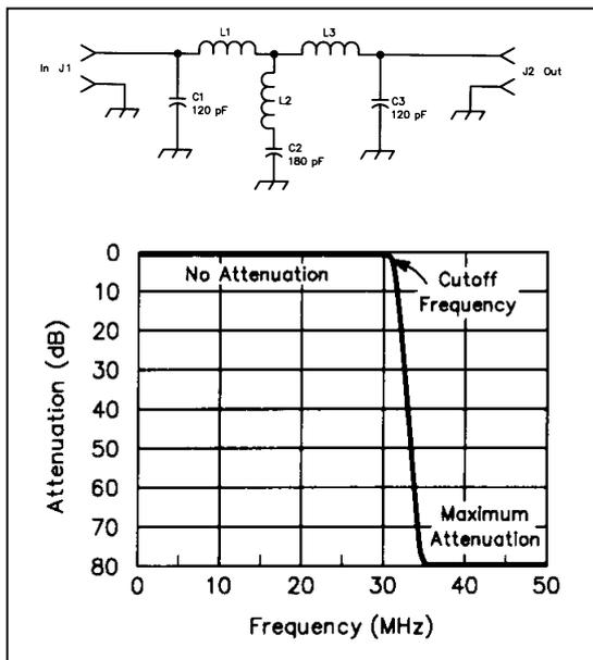
Une façon de séparer les signaux consiste à les séparer en fréquence. Les filtres peuvent ainsi avoir une grande atténuation pour certaine fréquence et très peu pour d'autres.
