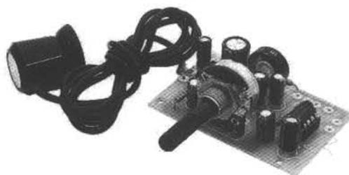
Il faut placer le capteur à ventouse dans le point de l'appareil téléphonique qui, expérimentalement, résulte être le plus approprié.
