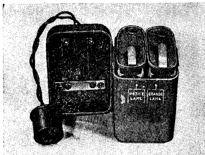
B. — Un boîtier pour deux piles et sa sortie par un bouchon femelle. Les barrettes établissant les contacts sont fixées sous le couvercle.
